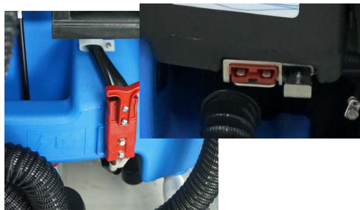
轻松打开机身盖可装电瓶或检查线路
